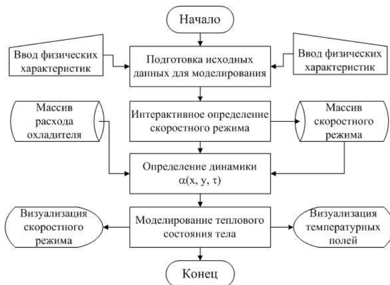
Рис. 3. Функциональная схема взаимосвязи основных компонент программного продукта «Steel & Speed»
