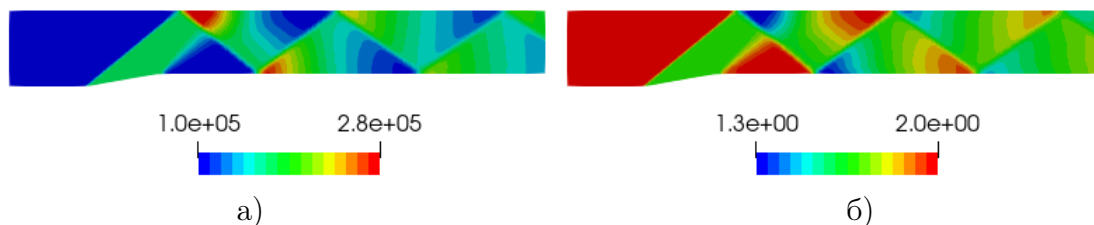
Рис. 1. Распределение полей давления (а) и числа Маха (б), полученные с использованием решателя FGMRES
