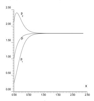
Рис. 5. Распределение давлений за фронтом замороженной ударной волны
