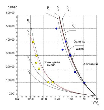
**Рис. 1**. Ударная адиабата алюминия и эпоксидной смолы построенная по Орленко Л.П. [20], Walsh M.H. [21], Holmes B.S. et al [19], Р. Кинслоу ( [28],  $p_D$ ), маркеры — экспериментальные данные [19, 22]
